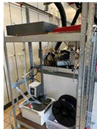
Figura 2: spinning della fibra prodotta in tecnologia TPS
